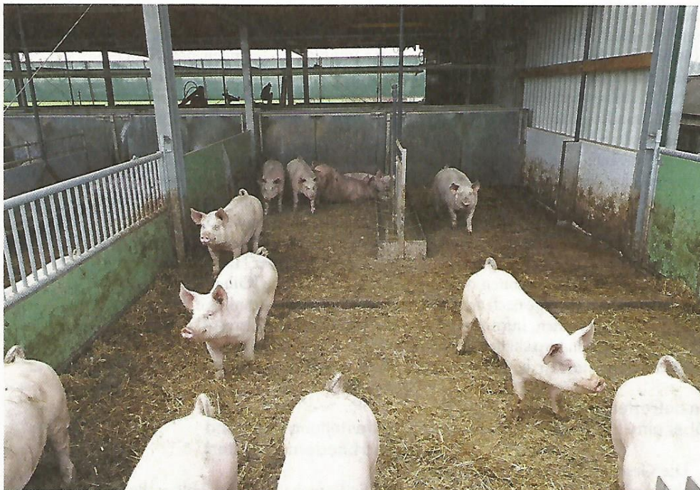
Der Maststall für Schweine ab knapp 50 kg wurde als Außenklimastall mit gedämmten Hütten errichtet und dient gleichzeitig als Strohlager. Fotos: Wucherpfennig
